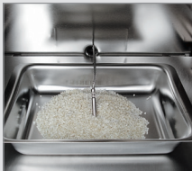
Tela de temperatura do espécime com sensor PT 100 (ED | FD | FED | FP | M | VD | VDL)
